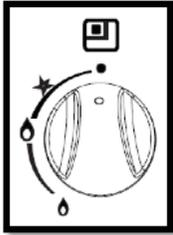
Para encender la llama, presione el pomo y girarlo hacia la izquierda hasta el símbolo de llama mínima. Para regular la llama girar el mando en la zona entre el máximo y el mínimo. Para activar el quemador, gire la perilla a la posición.
